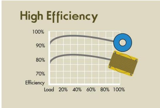
的磁芯是透過連續性的矽鋼片捲製繞組在整個圓周上對稱的擴展而成，所以形成了一個沒有縫隙的磁芯能夠創造較高的磁通密度。有別於傳統 EI 變壓器，因為磁芯的構造導致效率較低。(環形變壓器的效率大約 90%，EI 變壓器的效率大約 70%)。
